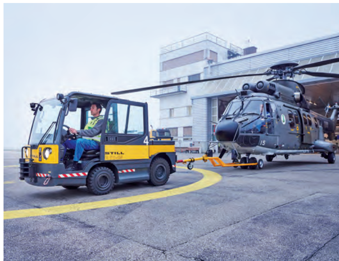
Kräftiger Elektromotor: der Helikopterschlepper der Luftwaffe.
